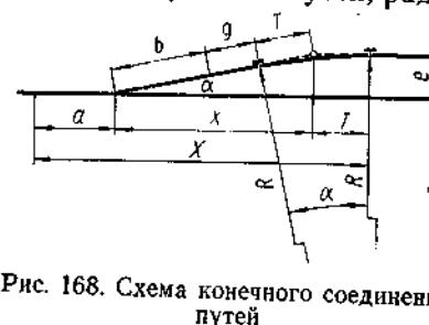
Рис. 168. Схема конечного соединения путей
