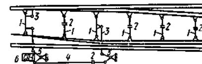
Рис. 124. Переводной механизм:
