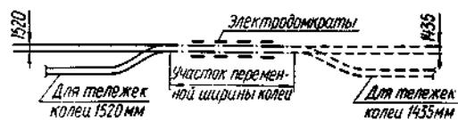
Рис. 210. Схема пункта перестановки тележек пассажирских вагонов
