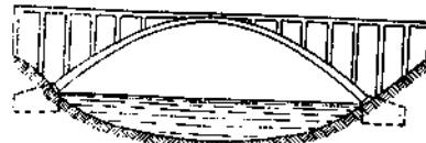
Рис. 61. Железобетонный арочный мост
