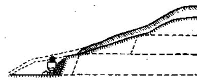
Рис. 257. Разработка карьера снизу вверх
