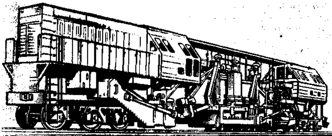
Рисунок 11.27 Выправочно-подбивочно-рихтовочная машина ВПО-3000.
